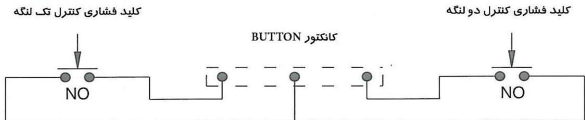
در صورتی که در، دارای دو لنگه باشد، موتور دری که اول باز میشود و قفل روی آن نصب میگردد Motor 1 محسوب شده و موتور لنگه دیگر Motor 2 خواهد بود.
